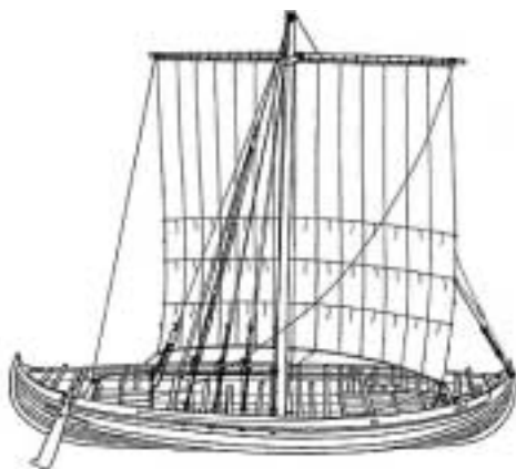
Fig. 4. Rekonstruktionsritning av det ca 16 m långa och 4,5 m breda lastskeppet "Skuldelev 1".
